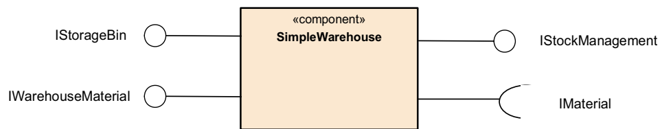
Abb. 3: Beispielkomponente Lagerverwaltung mit Schnittstellen
